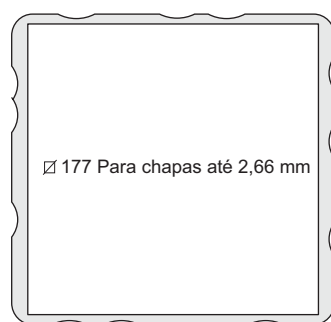
FURAÇÃO PARA MONTAGEM
