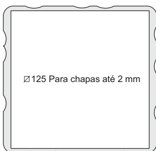
FURAÇÃO PARA MONTAGEM
