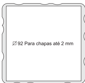
FURAÇÃO PARA MONTAGEM
